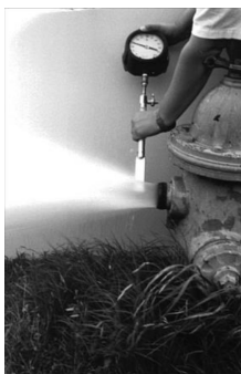
شکل ۲-۳- نمونه دبی سنج پیتو دستی در حال استفاده
